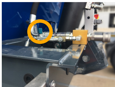
4 – Ajustement de la pression au moyen de la virole .
