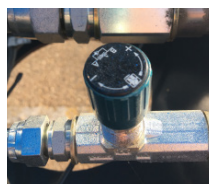
5 – Ouvrir ou fermer la virole d'ajustement à la pression souhaitée .
