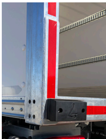
Cadre arrière renforcé et butoir caoutchouc
