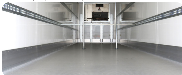
Suelo de aluminio, zócalo de aluminio y guías de amarre de carga
