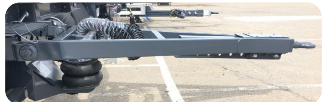
Opción elevación de lanza por diapres neumático
