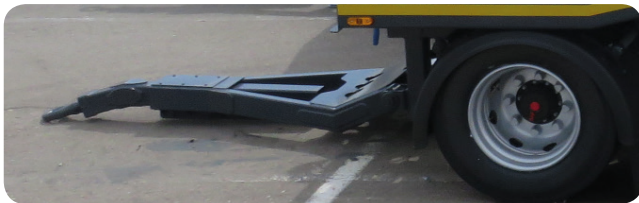
Flèche contre-coudée abaissable au sol pour faciliter l'accès du porteur
